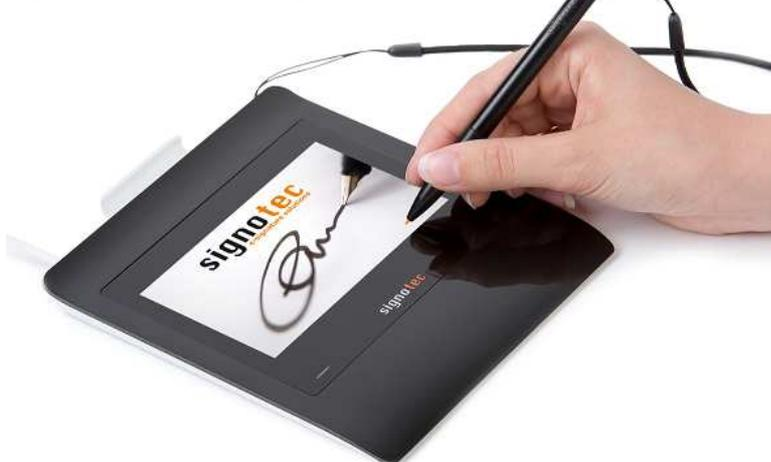
Bereits seit vielen Jahren sind die signotec Signatur-Lösungen bei zahlreichen IGEL Nutzern im Einsatz. Über eine Standard-Citrix-Funktionalität, das sogenannte „COM-Port-Mapping“, ist es möglich Unterschriften-Pads von signotec direkt an IGEL Endgeräten zu nutzen.
